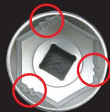
通常のボルト・ナットの締め付け・緩めはもちろんのこと、ソケット内に刻まれた特殊スリット加工で約85%まで角が丸くなったボルト・ナットを簡単に緩めることが可能!!
